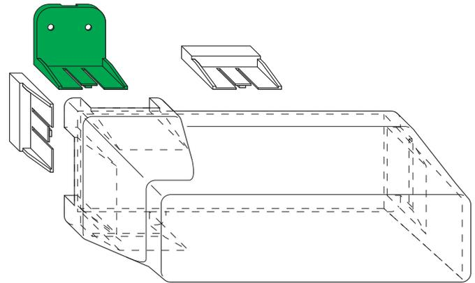
Zunächst müssen Sie die optimale Befestigung für die Haube zu ermitteln. Dazu stülpen Sie die Haube über den Türgriff und sehen, wo genügend Platz zum Anbringen der Befestigungslaschen ist. (Zeichnung: Möglichkeiten 1–4). Liegt die Position fest, drücken Sie dort die Befestigungswinkel hinein. Bei den anderen Möglichkeiten klicken Sie die Endabschlüsse ein.
